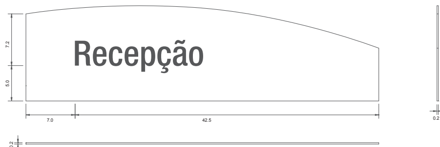
Chapa Metálica vistas ortográficas
